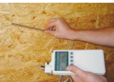
Obr. 13 K lokalizaci netěsností se používají speciální přístroje, např. anemometr, který měří okamžitou rychlost proudění vzduchu nebo emitör kouře. Ukázka precizně připojeného okna do konstrukce (dole). (Foto Stanislav Paleček)
