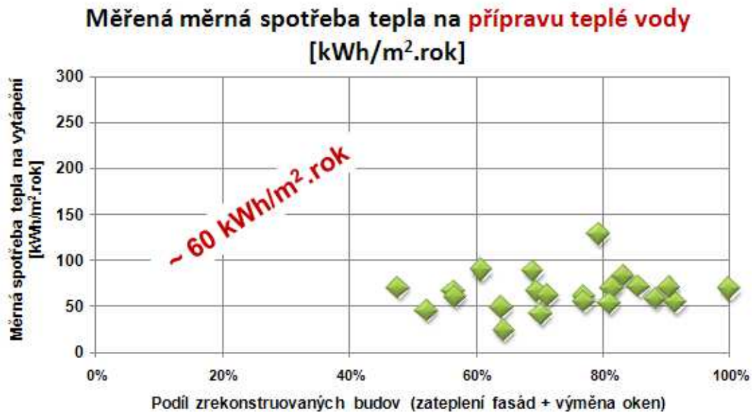
Obr. Měřená měrná spotřeba tepla na přípravu teplé vody. (ENVIROS 2010)
