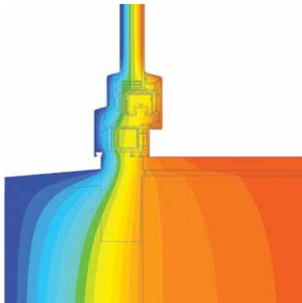
Obr. 2 Představená montáž systémem EJOT - Compacfoam
