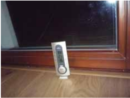
Abb. 7 Aussentemperatur -19,5\text{ }^{\circ}\text{C} , Temperatur am Fenster 21\text{ }^{\circ}\text{C} . Heizkörper seitlich vom französischen Fenster. Am Fenster hat sich über Winter kein Tauwasser gezeigt.
