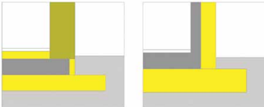
Obr. 7 Příklad rozdílného řešení styku stěny a základové desky u jednovrstvé konstrukce (vlevo) a dvouvrstvé konstrukce (vpravo). Řešení tepelné vazby je u jednovrstvé daleko horší, zároveň s odstíněním akumulční vrstvy železobetonové základové desky.
