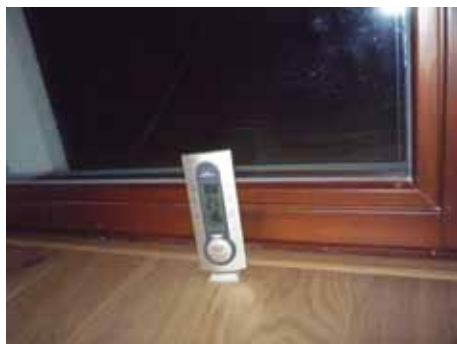
Obr. 7 Teplota v exteriéru -19,5\text{ }^{\circ}\text{C} , teplota poblíž okna 21\text{ }^{\circ}\text{C} . Otopné těleso vedle francouzského okna. Na okně se neobjevil po celou zimu kondenzát.
