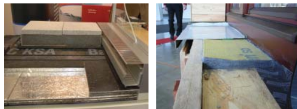
Obr. 9 Vakuové panely nachází uplatnění zejména při řešení komplikovaných konstrukčních detailů, např. při zaizolování roletového boxu, podlahy na terase, podlahy u rekonstrukcí s omezenou světlou výškou apod. V zahraničí i u nás jsou však i realizace, kde byla provedena kompletní izolace domu pomocí systému vakuových panelů – fasáda, střecha, podlaha. Materiál nelze řezat a při aplikaci je nutné důsledně chránit obal před porušením.
